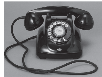
4号自動式卓上電話機 1950（昭和25）年に誕生した 4号自動式卓上電話機 「NTT技術史料館」提供
