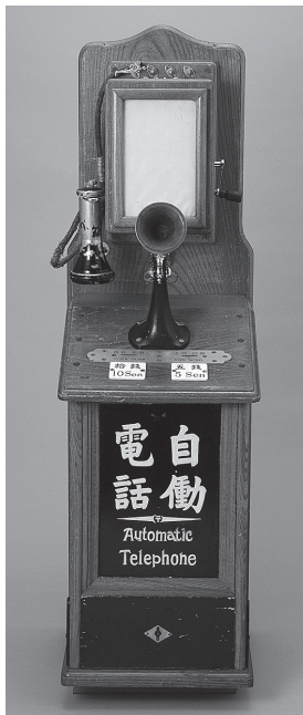
磁石式公衆電話機 初期の公衆（自動）電話 1925（大正14）年 「NTT技術史料館」提供
